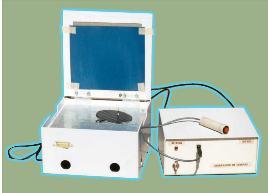
Figura 1. Aparato registrador de movimiento circular.
